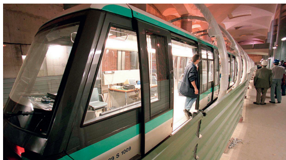
▲ Le système embarqué dans la ligne 14 du métro parisien (Météor) permet un fonctionnement sans conducteur.
