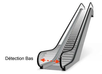
Réalise l'algorigramme permettant, dés la détection d'une personne la mise en marche d'un escalator de bas en haut.
