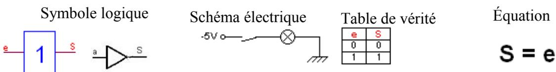
L'état de la sortie est égal à l'état de l'entrée, cette fonction ne présente par d'intérêt d'un point de vue logique mais peut être utile d'un point de vue technologique.
