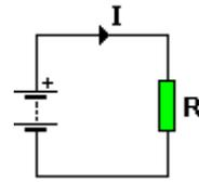
Si R est une résistance, le courant va être proportionnel à sa conductance (inverse de la résistance)
