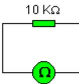
Attention : Pour mesurer une résistance, l'élément à mesurer doit être isolé du circuit.
